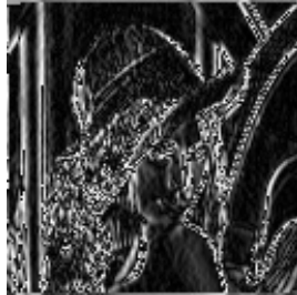
(b) Lenna après passage dans le filtre Sobel de détection de contours verticaux
